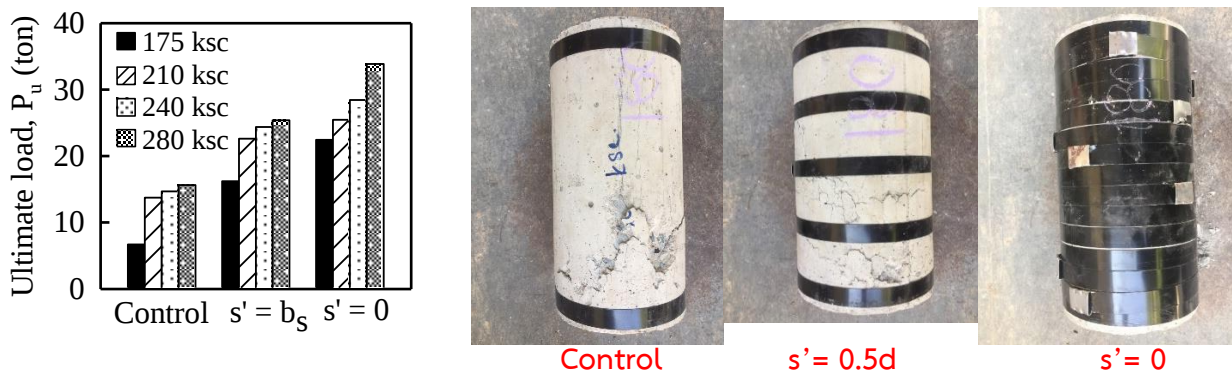
รูปที่ 7 ผลการศึกษาประสิทธิภาพของตัวอย่างคอนกรีตเสริมแรงด้วย PTMS และภาพการวิบัติของตัวอย่างคอนกรีต โดย Keerathanikkul and Imjai [12]
