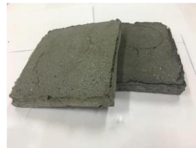
รูปที่ 1 (ก) น้ำยางพาราที่ถูกเทลงในแบบภายในเตาอบ (ข) ชิ้นงานผลิตภัณฑ์ที่ได้
