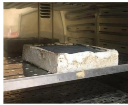
รูปที่ 1 (ก) น้ำยางพาราที่ถูกเทลงในแบบภายในเตาอบ (ข) ชิ้นงานผลิตภัณฑ์ที่ได้
