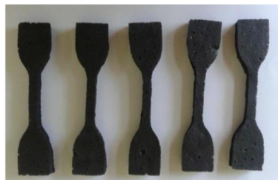
รูปที่ 2 ชิ้นงานโฟมยางพาราที่เสริมแรงด้วยผงถ่านจากขี้ขาวโพดที่ใช้ในการทดสอบการทนต่อแรงดึง
