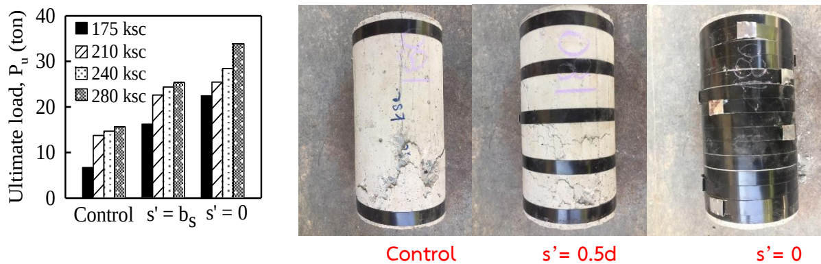
รูปที่ 7 ผลการศึกษาประสิทธิภาพของตัวอย่างคอนกรีตเสริมแรงด้วย PTMS และภาพการวิบัติของตัวอย่างคอนกรีต โดย Keerathanikkul and Imjai [12]
