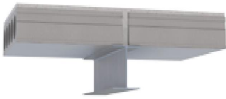
(ก) ระบบพื้นบนคานเหล็กรูปพรรณ
