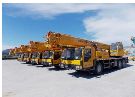
รูปที่ 1 แสดงปั้นจั่นแบบเคลื่อนที่ติดตั้งบนรถบรรทุก (Truck Crane)
