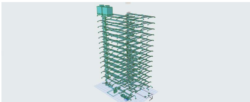
รูปที่ 5 แสดงงานระบบปรับอากาศของทุกระดับชั้น
