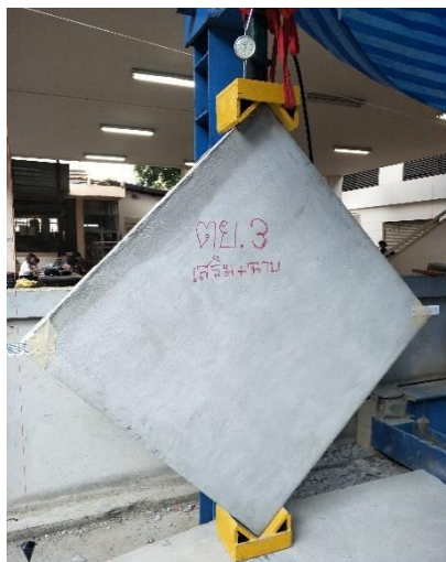
รูปที่ 4 การติดตั้งเครื่องมือทดสอบหาความสามารถในการรับแรงเฉือนของผนังก่อ
