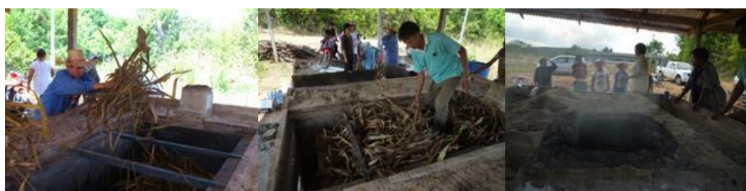
รูปที่ 1 เตาเผาที่ใช้ในการเผาถ่านจากใบสับปะรด
