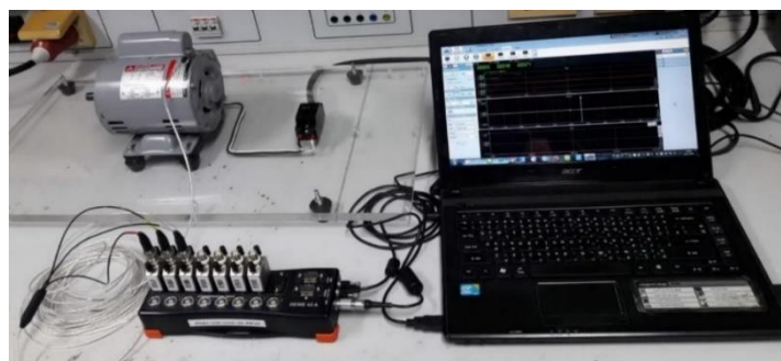
รูปที่ 4 การติดตั้งอุปกรณ์วัดความสั่นสะเทือนร่วมกับ Data Acquisition DEWE 43
