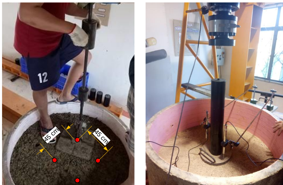
ก) การทดสอบการเจาะแบบหยั่งเบา ข) การทดสอบการรับน้ำหนักของชั้นดิน
