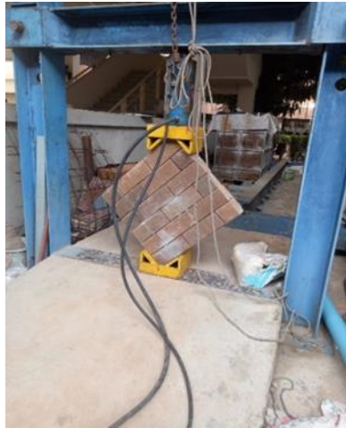
รูปที่ 6 การทดสอบผนังอิฐบล็อกประสานในห้องปฏิบัติการ
