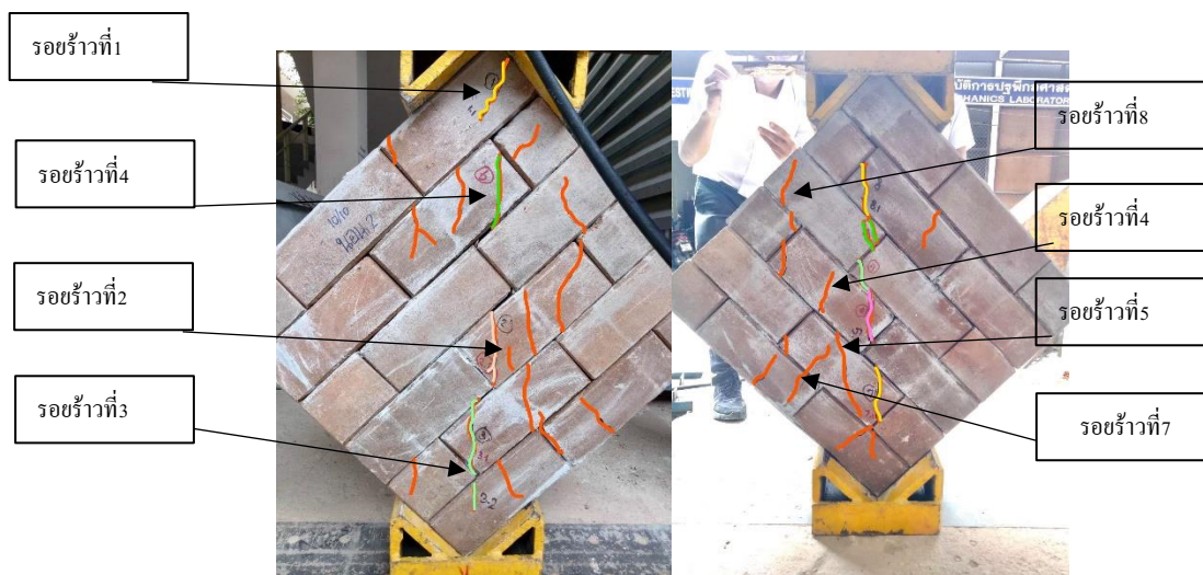
รูปที่ 7 ตัวอย่างแสดงการเสียหายของผนังที่เสริมกำลังด้วยเหล็กเสริมในแนวนอน
