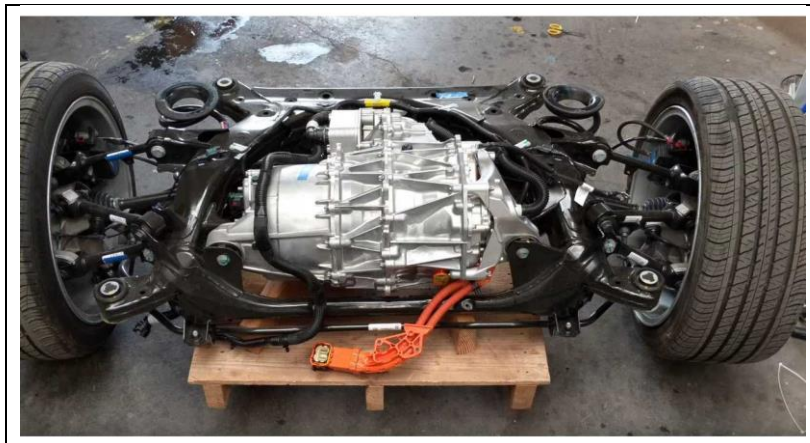
รูปที่ 7 ชุดเครื่องยนต์ไฟฟ้าของรถไฟฟ้ารุ่นโมเดล 3 จากบริษัทเทสลา
