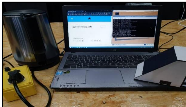
รูปที่ 11 การเปิดและปิดกาต้มน้ำด้วยเสียงผ่านไมโครโฟน
