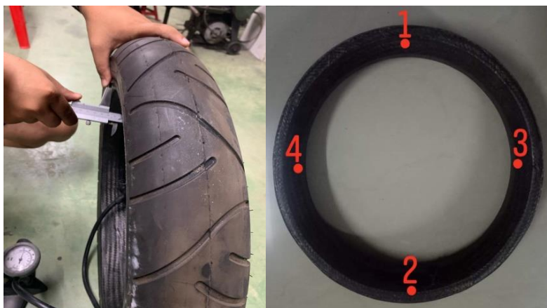
รูปที่ 10: หาค่าขอบล้อคาร์บอน หลังเติมลม 35 psi 50 psi 65 psi 75 psi
