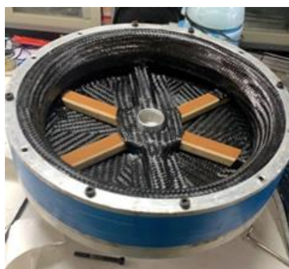
รูปที่ 6: การขึ้นก้านล้อคาร์บอนไฟเบอร์
