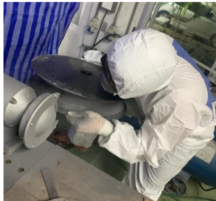
รูปที่ 7: ขัดขอบล้อคาร์บอนไฟเบอร์
