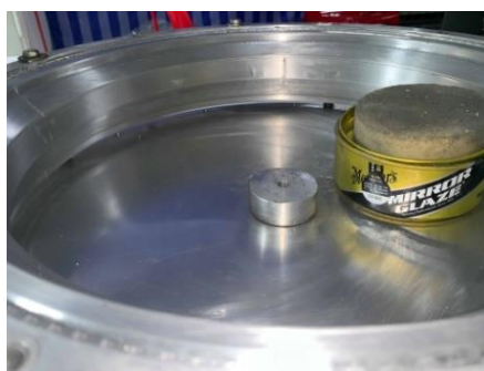
รูปที่ 2: การลงแฉกและขัดโมลล้อยานยนต์ไฟฟ้าต้นแบบ
