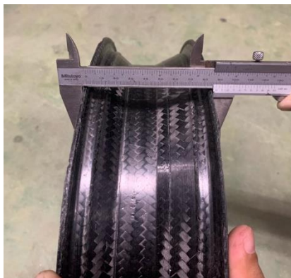
รูปที่ 9: หาค่าขอบล้อคาร์บอน ก่อนเติมลม
