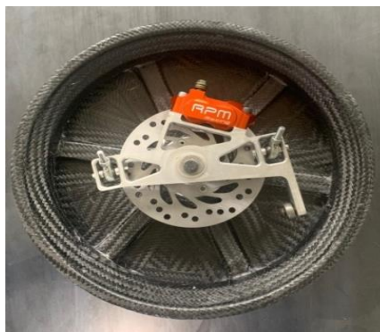
รูปที่ 8: เจาะรูยึดดุมล้อคาร์บอนไฟเบอร์
