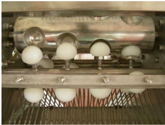
รูปที่ 3 ระบบการคั้นน้ำส้มแบบโรตารีหลายชุดคั้น
