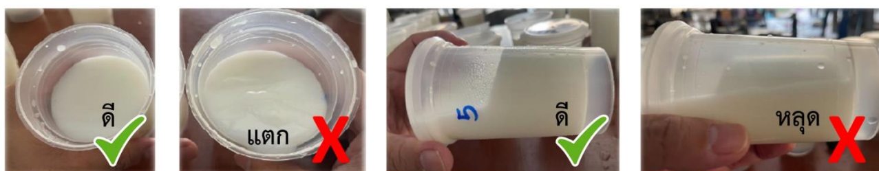
รูปที่ 4 จุดตรวจสอบความเสียหายหลังการบรรจุ
