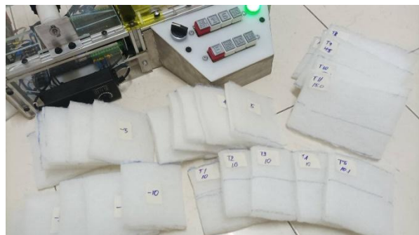
รูปที่ 11 การนับจำนวนฟิลเตอร์กรองอากาศที่ถูกตัดที่ขนาด 10 และ 15 เซนติเมตร
