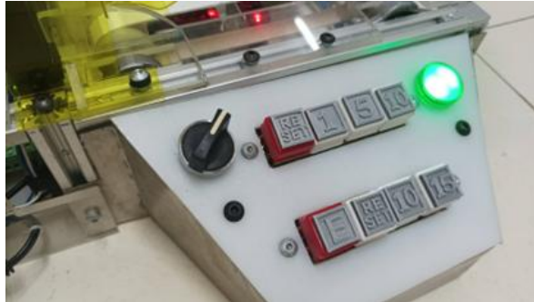
รูปที่ 9 แดงฟังก์ชันในการเลือกขนาดและจำนวนในการตัดฟิลเตอร์กรองอากาศ
