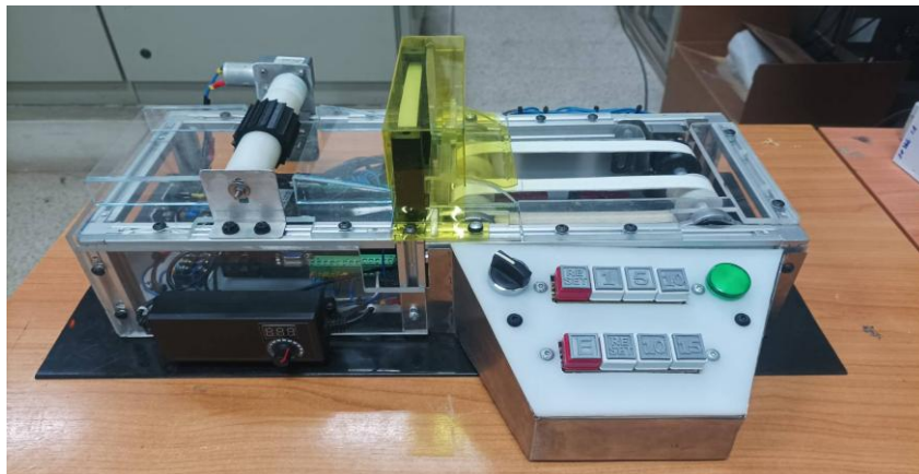
รูปที่ 8 ชุดจำลองเครื่องตัดฟิลเตอร์กรองอากาศที่สร้างเสร็จสมบูรณ์
