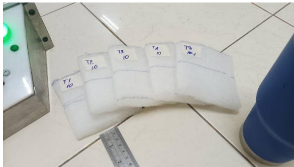
รูปที่ 10 ฟิลเตอร์กรองอากาศที่ตัดด้วยชุดจำลองที่ขนาด 10 และ 15 เซนติเมตร
