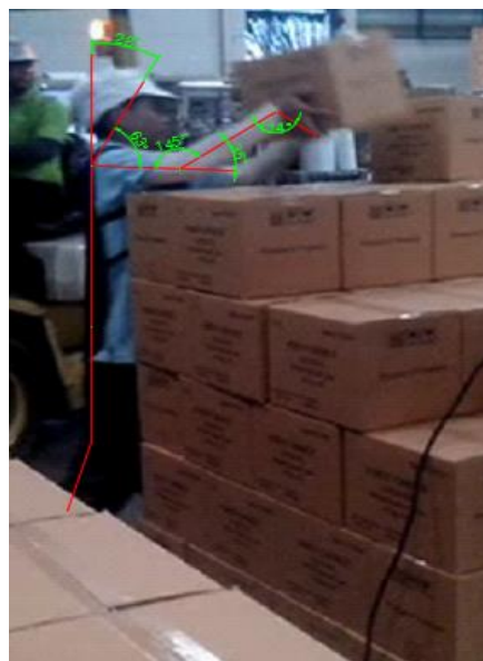
รูปที่ 7 การประเมินท่าทางการยกกล่องจากสายพานเรียงบนพาเลตก่อนปรับปรุง
