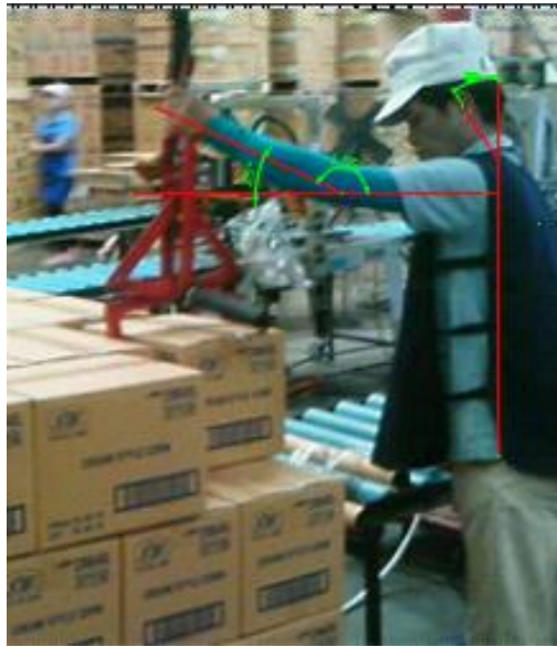
รูปที่ 10 การประเมินท่าทางการยกกล่องจากสายพานเรียงบนพาเลตหลังปรับปรุง
