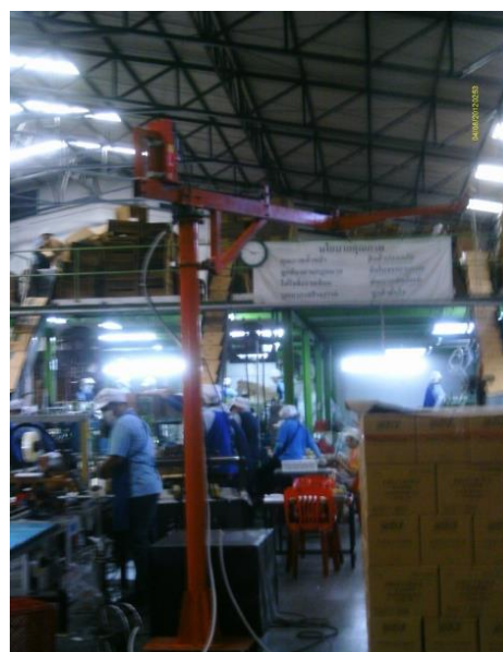
รูปที่ 9 อุปกรณ์เข้ามาช่วยในการช่วยยกกล่องบนสายพานไปเรียงบนพาเลต
