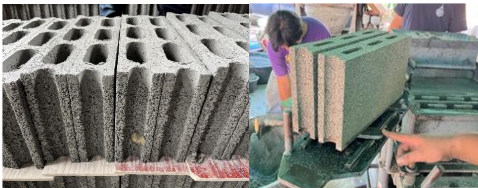
รูปที่ 4 การนำอิฐบล็อกที่อัดขึ้นรูปแล้วออกจากเครื่องอัดอิฐบล็อกไฮดรอลิก
