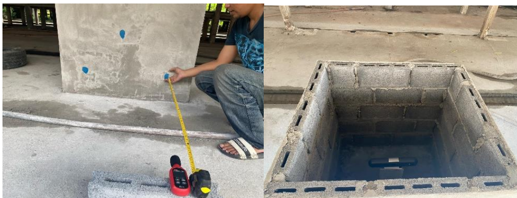
รูปที่ 8 การวางตำแหน่งการวัดค่าความชื้นและการเตรียมอุปกรณ์ส่งคลื่นเสียง
