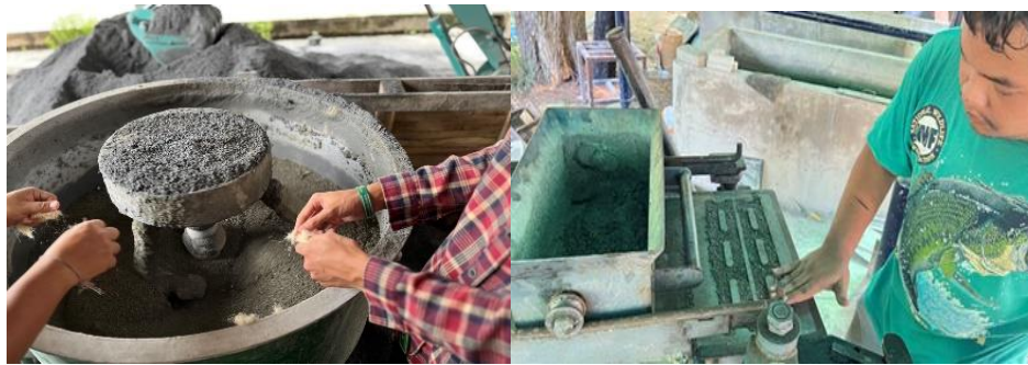
รูปที่ 3 การเทส่วนผสมลงในแม่ผสมปูน และนำส่วนผสมเทลงบล็อก
