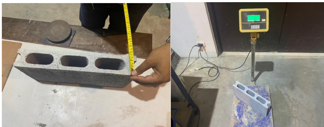
รูปที่ 5 วัดขนาดก้อนตัวอย่าง และชั่งน้ำหนักก้อนตัวอย่าง
