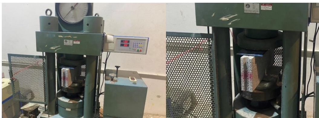
รูปที่ 6 นำก้อนตัวอย่างเข้าเครื่องทำสอบและทำการทดสอบก้อนตัวอย่างพร้อมบันทึกค่า
