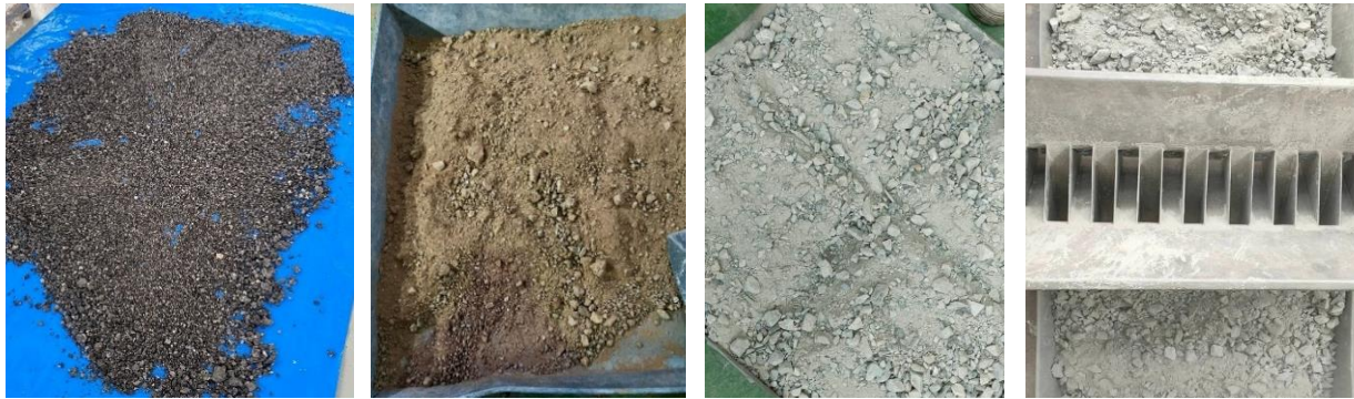
รูปที่ 2 ตัวอย่าง RAP, ดินลูกรัง, หินคลุก และการแบ่งตัวอย่างดินด้วยเครื่องแบ่งตัวอย่างวัสดุมวลรวม (Sample Splitter Riffle)
