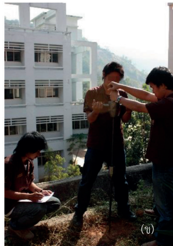
รูปที่ 2 การสำรวจด้วยการเจาะหยั่งเบา (ก) แนวตำแหน่งการทดสอบ (ข) การทดสอบ KPT (ค) กรวยทดสอบ
