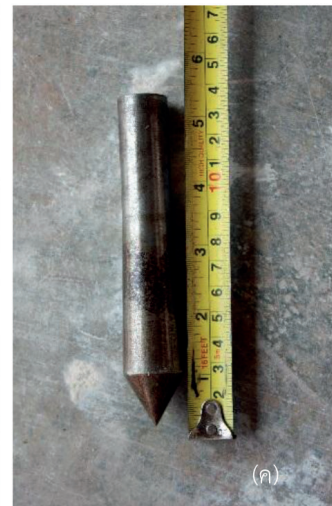
รูปที่ 2 การสำรวจด้วยการเจาะหยั่งเบา (ก) แนวตำแหน่งการทดสอบ (ข) การทดสอบ KPT (ค) กรวยทดสอบ
