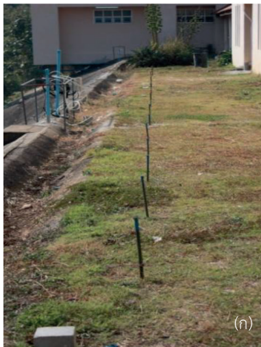
รูปที่ 2 การสำรวจด้วยการเจาะหยั่งเบา (ก) แนวตำแหน่งการทดสอบ (ข) การทดสอบ KPT (ค) กรวยทดสอบ
