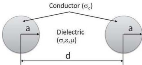
รูปที่ 1 โครงสร้างของสายส่งสัญญาณแบบสองสาย
