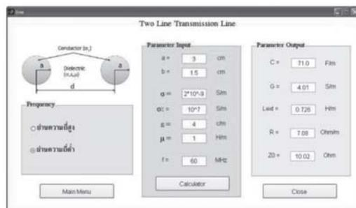
รูปที่ 6 การคำนวณค่าพารามิเตอร์ของสายส่งสัญญาณแบบสองสาย
