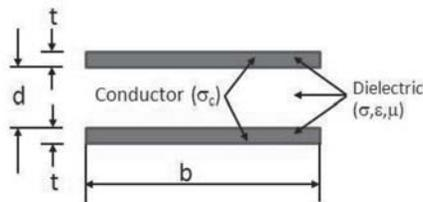
รูปที่ 2 โครงสร้างของสายส่งสัญญาณแบบระนาบคู่
