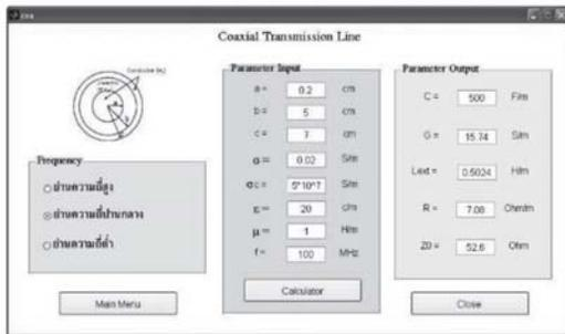
รูปที่ 7 การคำนวณค่าพารามิเตอร์ของสายส่งสัญญาณแบบโคแอกซ์
