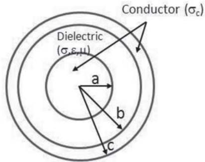
รูปที่ 3 โครงสร้างของสายส่งสัญญาณแบบโคแอกซ์
