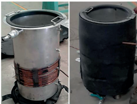
ข) ถังน้ำร้อนก่อนและหลังหุ้มฉนวน
