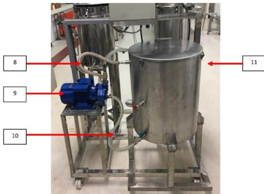
รูปที่ 3 ส่วนประกอบของเครื่องตองสุญญากาศ ได้แก่ กล่องควบคุมอุปกรณ์ (1) ถังพักของเหลว (2) สายยางสำหรับลำเลียงของเหลว (3) สายยางดูดอากาศ (4) ถังสุญญากาศ (5) ถังสองชั้นสำหรับเติมน้ำควบคุมอุณหภูมิ (6) สายยางสำหรับถ่ายของเหลวออก (7) สายยางถ่ายเทน้ำที่หล่อเลี้ยงปั้ม (8) ปั้ม liquid ring (9) สายยางสำหรับดูดน้ำที่หล่อเลี้ยงปั้ม (10) ถังพักน้ำสำหรับดูดเลี้ยงปั้ม (11)
