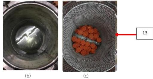
รูปที่ 4 ส่วนประกอบของเครื่องตองสุญญากาศแสดงมุมมองด้านข้าง (a) และมุมมองของถังพักน้ำเชื่อม และมุมมองด้านบนของถังสุญญากาศ แสดงส่วนประกอบได้แก่ ตัวปรับความดันสุญญากาศ (12) และตะแกรงใส่ตัวอย่าง (13)
