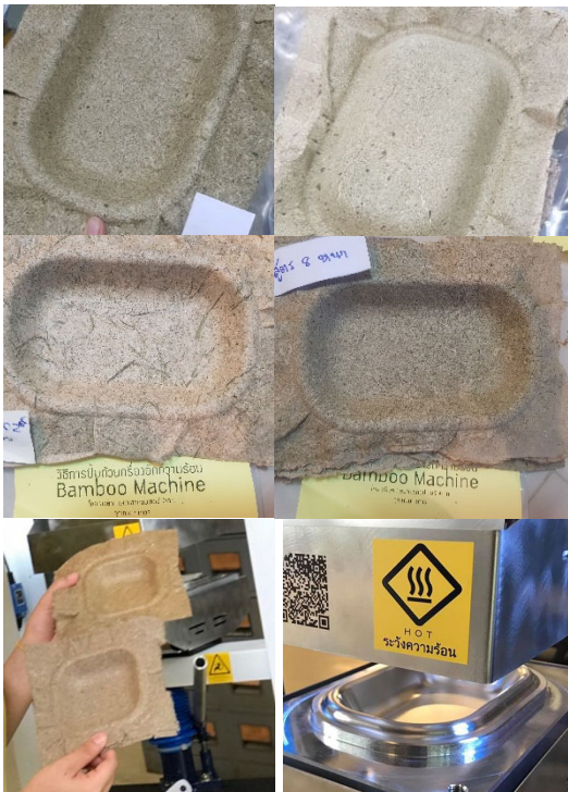
รูปที่ 19 การทดลองกระบวนการผลิต การขึ้นรูปด้วยเครื่องอัดความร้อน Bamboo บริษัท กษมาเฮริคอปเตอร์ จำกัด [16]
