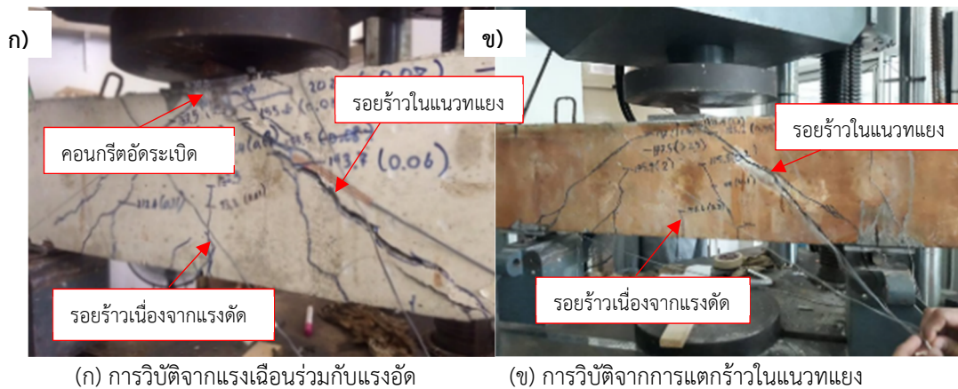
รูปที่ 8 รูปแบบการวิบัติของตัวอย่างทดสอบ
