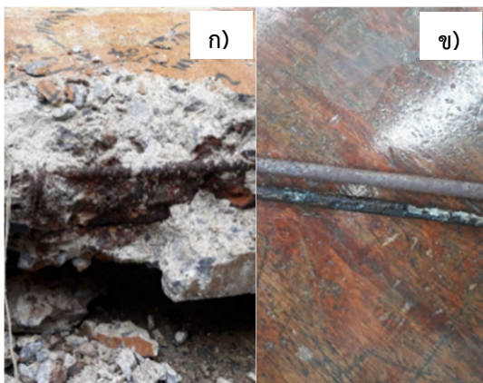
รูปที่ 7 เหล็กเสริมที่อยู่ภายในตัวอย่างคานคอนกรีตหลังสร้างสภาวะแวดล้อมจำลอง
