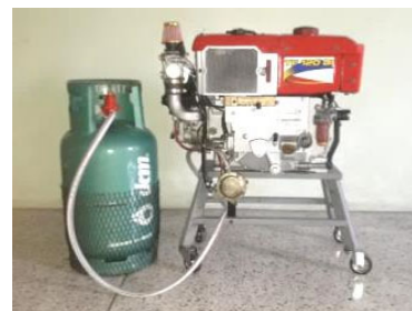
รูปที่ 12 เครื่องยนต์ที่ดัดแปลงและติดตั้งอุปกรณ์ที่เสร็จสมบูรณ์
