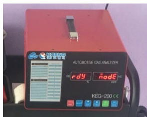
รูปที่ 14 เครื่องวิเคราะห์ก๊าซไอเสีย รุ่น Koeng KEG-200
