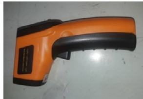
รูปที่ 13 อินฟาเรดเทอร์โมมิเตอร์ รุ่น Benetech GM320
