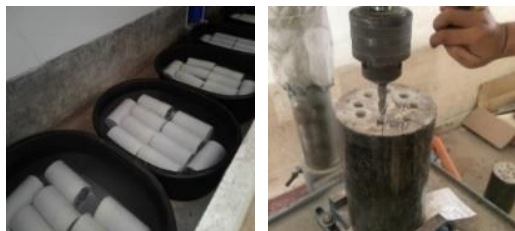
รูปที่ 1 การแพร่สารละลายโซเดียมคลอไรด์และการเก็บผงตัวอย่างคอนกรีต
