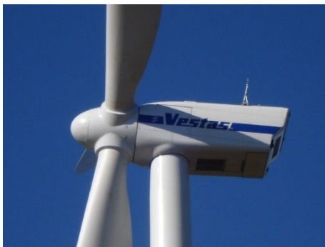
รูปที่ 11 กังหันลมผลิตไฟฟ้ายี่ห้อ Vestas V90 ขนาด กำลังการผลิต 3 เมกกะวัตต์ [10]
