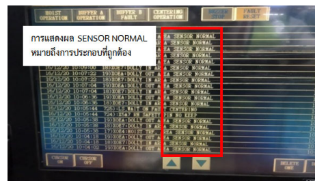
รูปที่ 12 การแสดงผลการประกอบชิ้นส่วนถูกต้องหรือไม่ถูกต้องที่หน้าจอกล่องควบคุมหลัก
