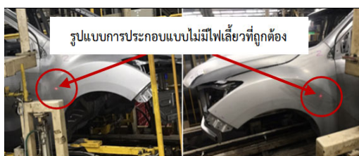
รูปที่ 13 การประกอบชิ้นส่วนบังโคลนหน้าแก้มข้างรถยนต์ทั้ง 2 ข้าง ที่ไม่มีรูไฟเลี้ยวเหมือนกันอย่างถูกต้อง
