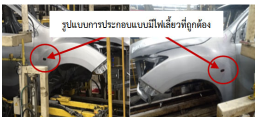
รูปที่ 14 การประกอบชิ้นส่วนบังโคลนหน้าแก้มข้างรถยนต์ทั้ง 2 ข้าง ที่มีรูไฟเลี้ยวเหมือนกันอย่างถูกต้อง
