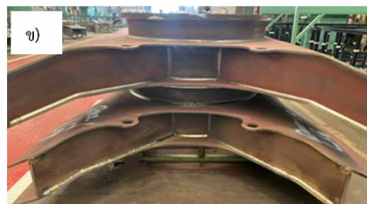
รูปที่ 1 ก) โครงสร้างการรองรับชิ้นส่วนต่างๆ ของตัวถัง ข) ชิ้นส่วนตัวถังรถชุด-ตก
