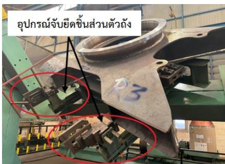
รูปที่ 7 ตำแหน่งการติดตั้งอุปกรณ์จับยึดชิ้นส่วนตัวถัง
