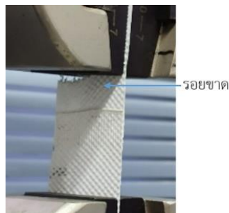
รูปที่ 6 รอยขาดภาระขาดสูงสุดการเชื่อม (การทดลอง 20)
