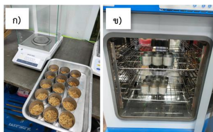
รูปที่ 1 ก) ข้าวเปลือกตัวอย่างที่บรรจุในถ้วยชั่งน้ำหนัก ข) เครื่องอบหาความชื้นแบบ Hot air oven
