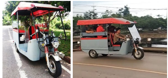
รูปที่ 8 แสดงรถสามล้อไฟฟ้าส่งกำลังด้วยระบบมอเตอร์ไฟฟ้าคู่ต้นแบบที่สร้างขึ้น
