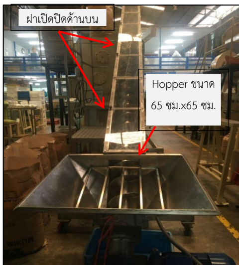
รูปที่ 10 โครงสร้างรางสกรูลำเลียงและท่อสกรูขนถ่ายลำเลียงสับและมีฝาเปิดปิดด้านบน
