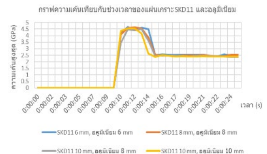
รูปที่ 4 ความเค้นเทียบกับช่วงเวลาของแผ่น SKD11 และ AL-7075 T6 ที่มุมยิง 0 องศา
