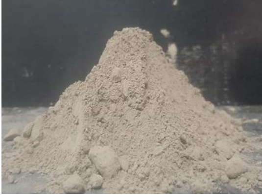
รูปที่ 1 ฝุ่นหินเหลือทิ้งจากโรงงานผลิตแอสฟัลต์คอนกรีต
