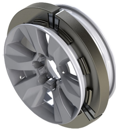
รูปที่ 23 รูปแบบวงล้อรันแฟลทที่ประกอบเข้ากับกระทะล้อ
