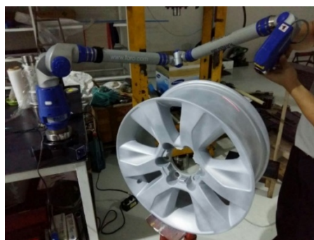
รูปที่ 3 การสแกนกระทะล้อด้วยเครื่องสแกนเลเซอร์ FARO Messurement FARO P06-05
