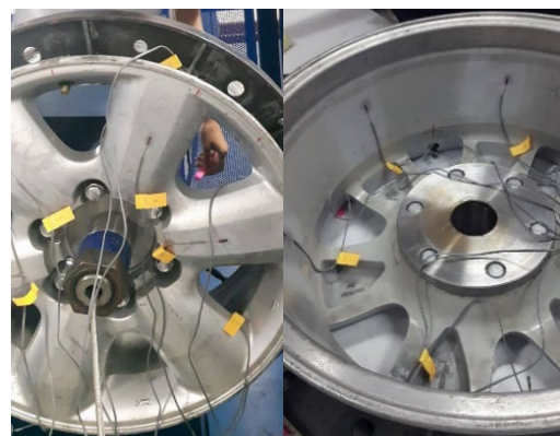
รูปที่ 7 การติดตั้งสเตรนเกจเข้ากับกระทะล้อและล้อรันแฟลท
