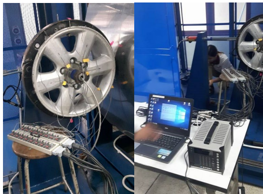
รูปที่ 8 การติดตั้งเครื่องมือทดสอบเข้ากับล้อรีนแพลทและกระทะล้อ
