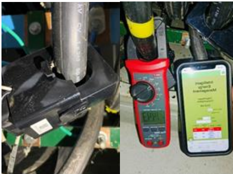
รูปที่ 1 การเก็บรวบรวมข้อมูลการใช้พลังงานใช้เซ็นเซอร์วัดกระแสไฟฟ้าร่วมกับระบบ IoT
