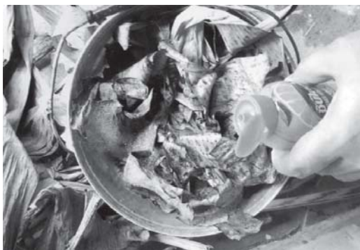
รูปที่ 1 แสดงการทดลองเตรียมเส้นใยจากพืชตระกูลกล้วยทางภาคเหนือโดยใช้ชันโลนเป็นตัวย่อยสลายให้นิ่มและหมักเป็นเวลา 1 คืน
