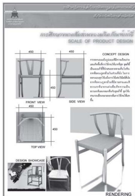
รูปที่ 9 แสดงผลการเขียนแบบและผลิตเก้าอี้ที่ใช้ภายในบ้านจากเส้นใยจากพืชตระกูลกล้วย
