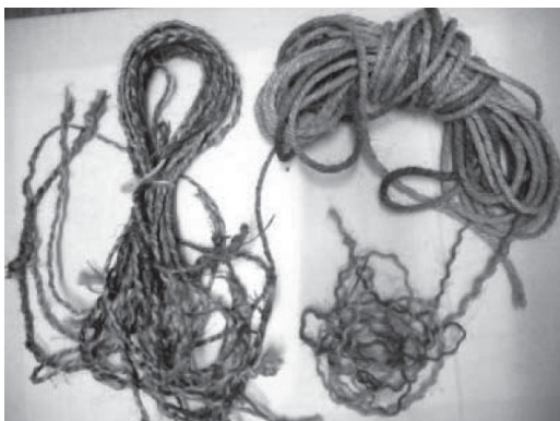
รูปที่ 7 การพันเกลียวเส้นใยจากพืชตระกูลกล้วยผสมกับเส้นใยปอ
