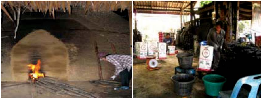
รูปที่ 3 การผลิตถ่านโกงกางแบบครบวงจร
