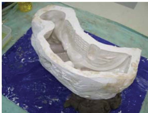
รูปที่ 2 ทำการหล่อแบบโดยใช้ปูนปลาสเตอร์เพื่อสร้างต้นแบบที่มีความละเอียด
