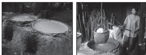
รูปที่ 5 น้ำเกลือเริ่มแห้งและการตักเกลือออกมาพักไว้ในตะกร้าไม้ไผ่
