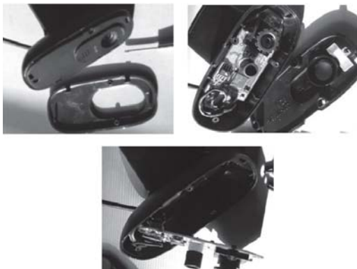
รูปที่ 2 ขั้นตอนการถอดแผงวงจรตัวกล้อง
