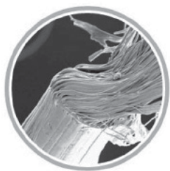
รูปที่ 3 เส้นใยสององค์ประกอบชนิดกระจายตัวในเส้นใยที่มีเส้นใยจำนวน 600 เส้นใย ในเส้นใยเดี่ยว (Hills, Inc., 2015)
