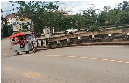
รูปที่ 9 การทดสอบการขับขี่รถขึ้นทางชันที่ระดับความเอียง 15 องศา
