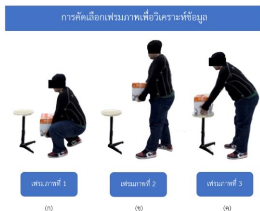
รูปที่ 4 การคัดเลือกเฟรมภาพสำหรับการวิเคราะห์ผล (ก) ท่าทางขณะยกที่ระดับเข่า (ข) ท่าทางการยกที่ระดับเอว และ (ค) ท่าทางการยกขณะเสร็จสิ้น
