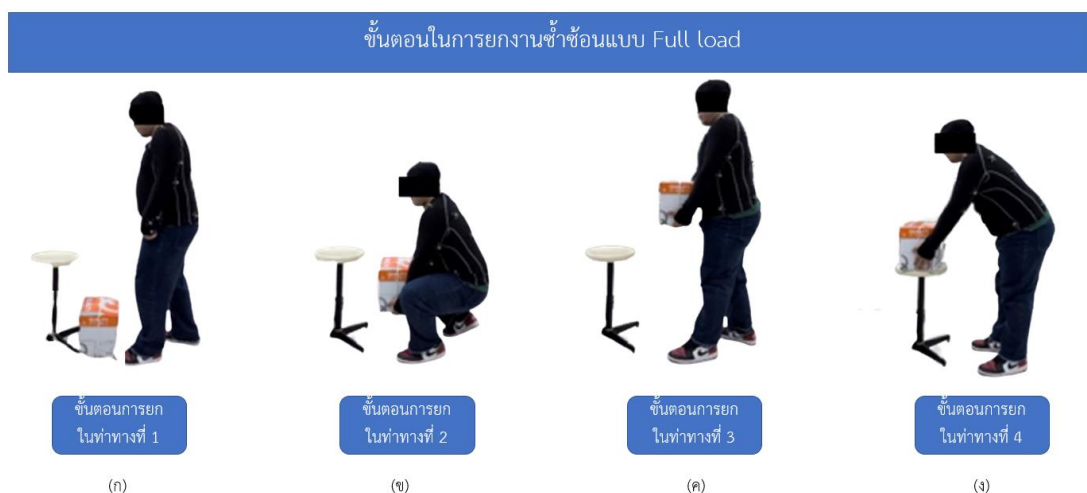
รูปที่ 3 ขั้นตอนการยกงานเข้าซ้อนแบบ full load (ก) ยืนในจุดเริ่มท่าทางปฏิบัติงานยก (ข) ย่อเข่าลงหลังตรงเริ่มยกที่ระดับพื้นถึงระดับเข่า (ค) การยกจากระดับเข่าถึงระดับเอว และ (ง) การยกจากระดับเอวไปยังจุดวางสุดท้าย
