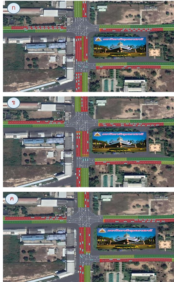
รูปที่ 9 แสดงการวิเคราะห์การลดช่องทางการจราจรสำหรับ ก) S13 แบบลดหนึ่งช่องทาง ข) S14 แบบลดหนึ่งช่องทาง และ ค) S15 แบบลดสองช่องทาง
