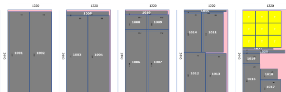
รูปที่ 11 แบบแผนการตัดแผ่นไม้ตู้เสื้อผ้าแบบน็อคดาวน์ขนาด 1.2 เมตร
