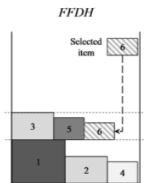
รูปที่ 2 รูปแบบการจัดเรียงไม้ FFDH
