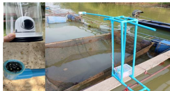
รูปที่ 2 อุปกรณ์ถ่ายรูปปลานิลแบบบนน้ำและใต้น้ำ
